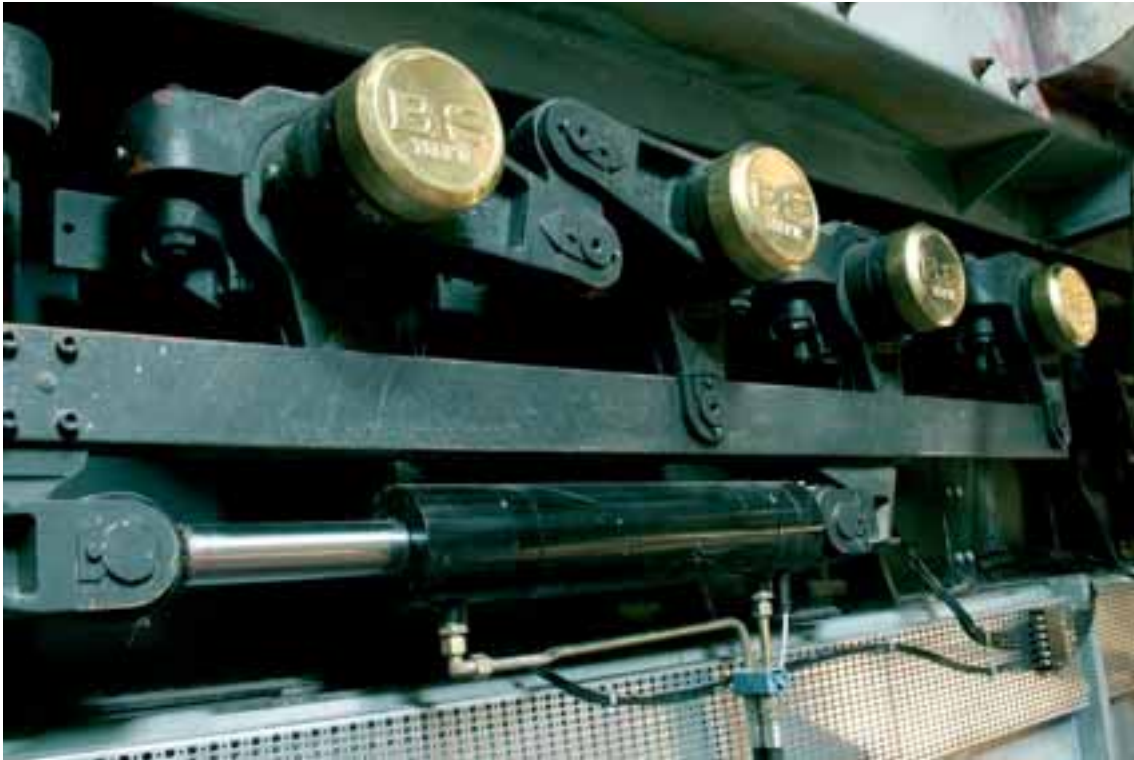
Bild 6: Antriebsmechanismus außerhalb des Feuerraums
