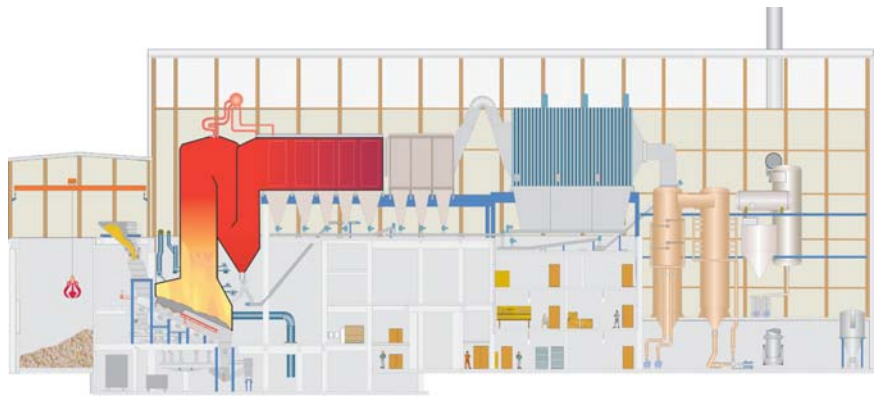
Corte de la planta de Reno-Nord
